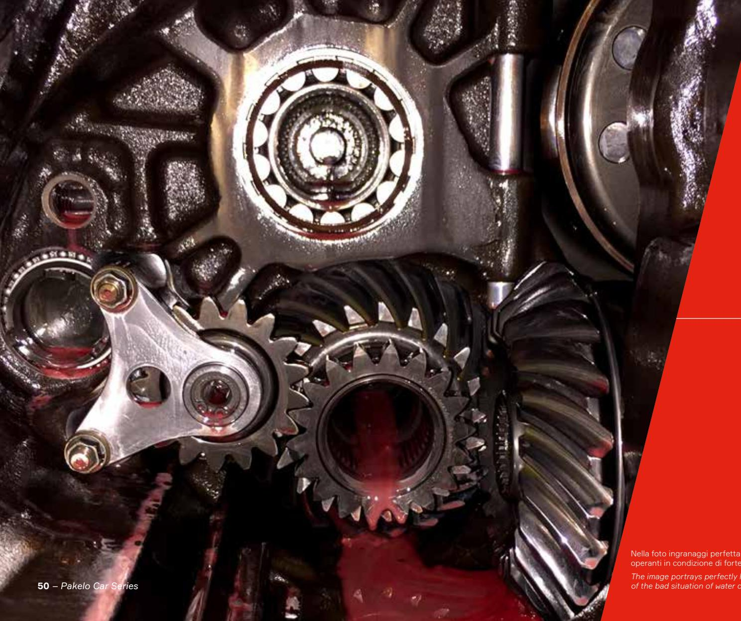
Nella foto ingranaggi perfettamente lubrificati anche se operanti in condizione di forte contaminazione d'acqua.
