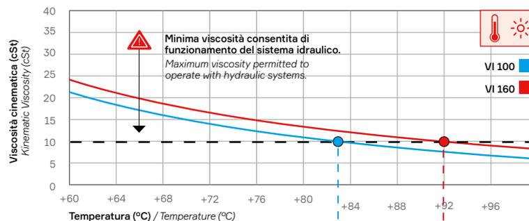
Un olio idraulico ISO 46 con VI 160 rispetto al VI 100 permette il funzionamento dell'impianto a temperature maggiori fino a circa 8°C.
