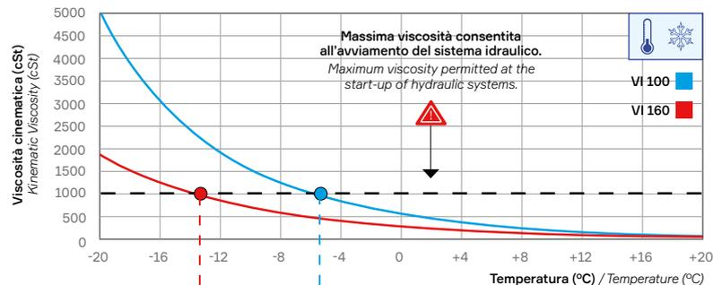
Un olio idraulico ISO 46 con VI 160 rispetto al VI 100 permette l'avviamento dell'impianto a circa 8°C in meno.
